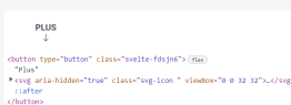
Figure: Les boutons « Plus/Moins ». Il faut leur donner une alternative plus explicite au moyen d'un attribut « aria-label », comme par exemple « Afficher plus/moins de texte ».
